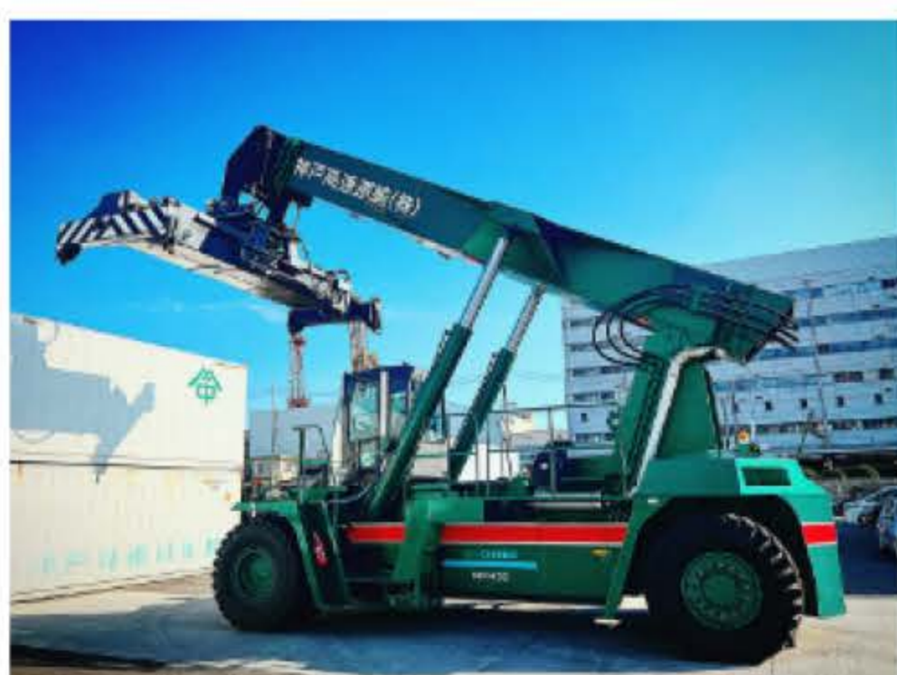
リーチスタッカー
